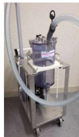
圧倒的な吸引力（揚程8m 50L/分）で、タンク底部、隅に堆積したヘドロ状スラッジをパワフルに吸引します。
